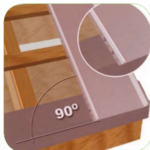
10. ábra A tetőlemez az ereszhez képest merőlegesen kell lefektetni. Az eresznél két csavarral rögzítsük a lemezt.
