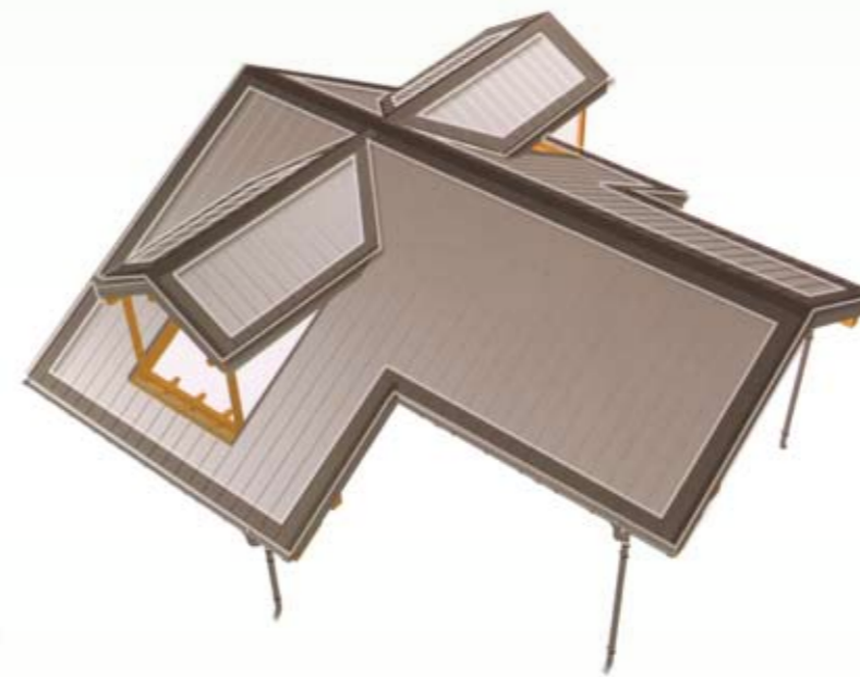
7. ábra A tető sarkai különösen ki vannak téve a szél hatásának
